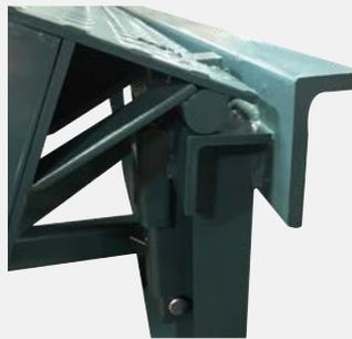
Todos los niveladores McGuire están fabricados con una construcción duradera de caja de cuatro lados. McGuire también tiene el único nivelador de muelle/andén que emplea una bisagra posterior de ancho completo montada por compresión, con una varilla de acero sólido de 3 cm (1") de diámetro.
